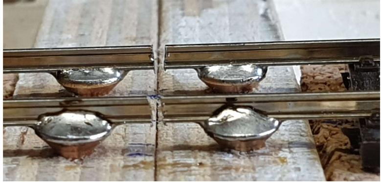
Pezzi di traversina possono essere utilizzati per nascondere i punti di saldatura.
